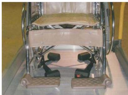
埋込み式ベルト型固定装置
