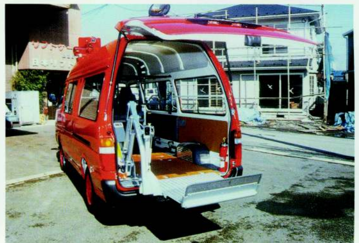
機材運搬用リフト
