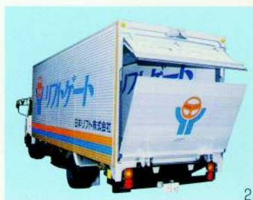
プレートを開くと自動的に上のドアが開きます
